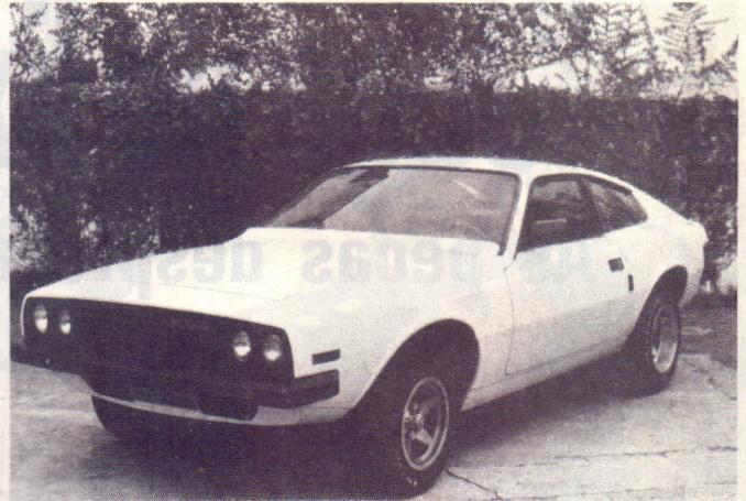
Puma GTB S-2, com motor e câmbio do Opala seis cilindros.
