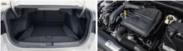
A capacidade do porta-malas é de 521 litros. Motor flex rende 128 cv com etanol
