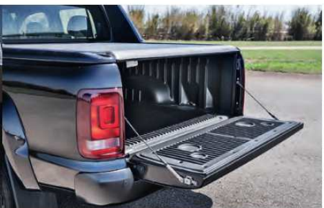
Tampa traseira tem sistema de amortecimento; motor e câmbio receberam mudanças eletrônicas
