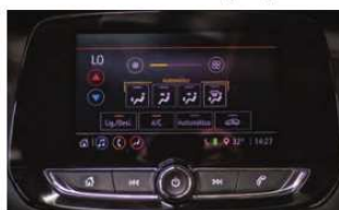
Central tem controles redundantes do ar-condicionado, além de rede Wi-Fi
