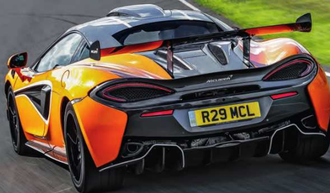
O aerofólio traseiro pode ser ajustado. A pressão aerodinâmica chega a 185 kg, a 250 km/h
