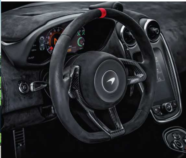
A mistura de Alcantara e fibra de carbono predomina na cabine. Dois cintos: de três (rua) e de seis pontos (pista)
