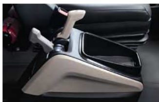
Alavancas controlam freio de estacionamento e também só do implemento
