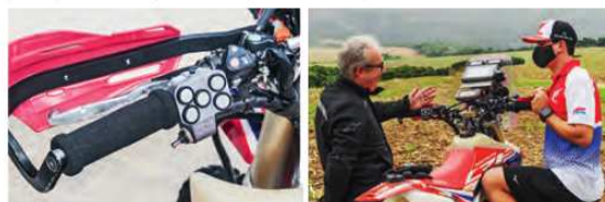
Disco maior, na dianteira, tanque adicional, na traseira, e torre de navegação (com comandos no guidão) foram as principais mudanças em relação à moto original
