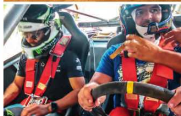
Gaiola de proteção e cinto de quatro pontos garantem a segurança
