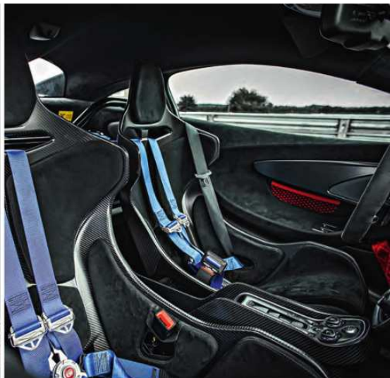
A mistura de Alcantara e fibra de carbono predomina na cabine. Dois cintos: de três (rua) e de seis pontos (pista)
