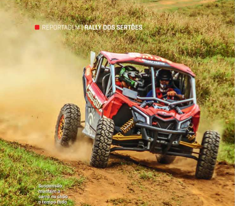
Gaiola de proteção e cinto de quatro pontos garantem a segurança
