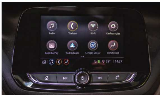
Botões físicos facilitam a operação da central multimídia MyLink no dia a dia
