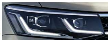
Faróis full-led são direcionais e têm função de alcance ampliada em largura e profundidade
