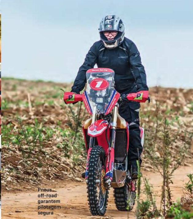
Disco maior, na dianteira, tanque adicional, na traseira, e torre de navegação (com comandos no guidão) foram as principais mudanças em relação à moto original
