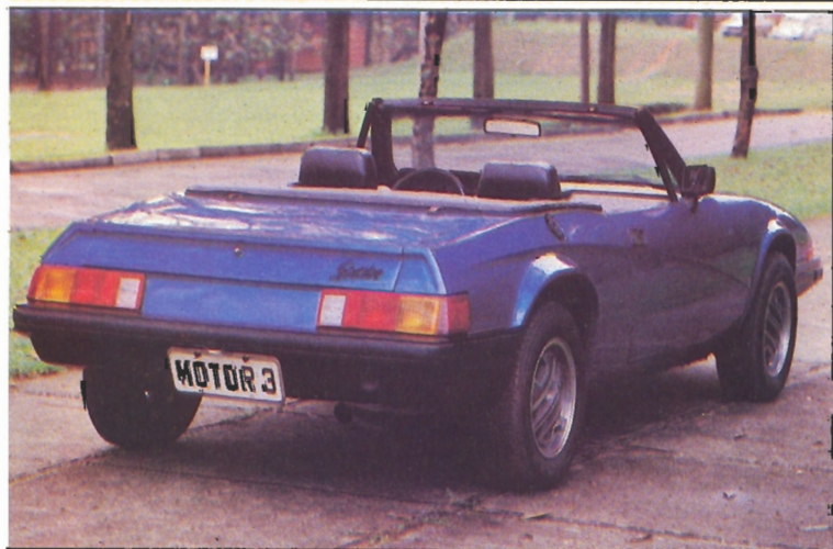
Elementos ópticos traseiros bem visíveis, envolvendo os para-lamas e protegidos pelo para-choques
