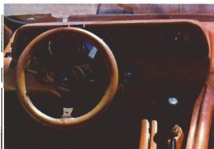
Uma tecla no painel aciona o motor da coluna de direção regulável
