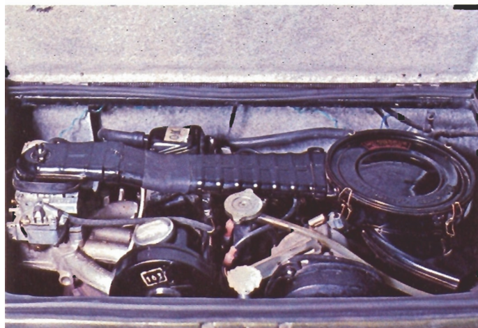
O motor Passat foi acoplado invertido na parte traseira
